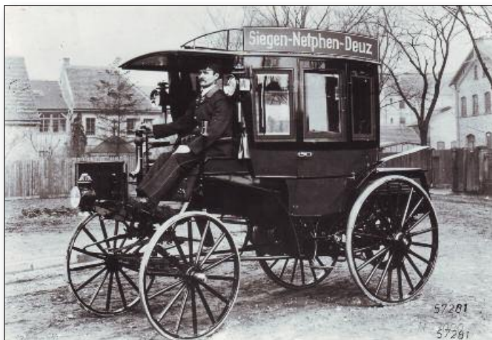
Das Bild des ersten Motoromnibusses der Welt wurde wahrscheinlich als Werksfoto in Mannheim aufgenommen, während sich der am Steuer posierende zukünftige Omnibusfahrer Karl Otto aus Nauholz im Netpherland dort zur Schulung aufhielt (Abb.: Sammlung Heimatverein Netpherland).
